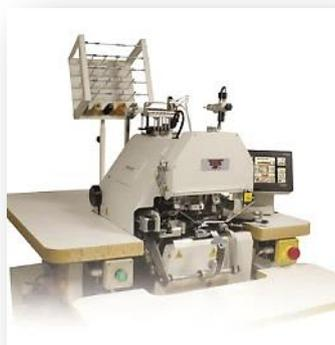
電子制御による糸のテンション、根巻きの高さやステッチの深さは電子プログラム。特殊専用糸だけでなく一般普通糸が使用できるなど数々の新しい特長を兼ね備えています。独自のハンドステッチ技術に加え、2つ穴・3つ穴・4つ穴平ボタンとシャンクボタンの切替えはタッチパネルで簡単に行えV字縫いも可能です。
